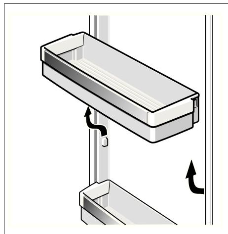
Voorraadvakken in de deur iets optillen en eruit halen.
